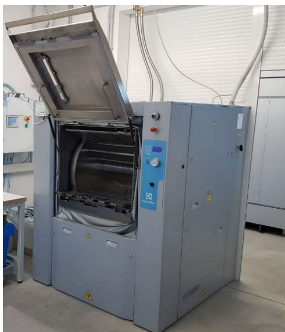
Figur 7 og 8. Eksempler på barrierevaskemaskiner fra ledende vaskemaskinprodusenter som kan programmeres for vask og desinfisering av åndedrettsvern.
