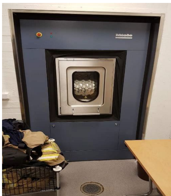
Figur 7 og 8. Eksempler på barrierevaskemaskiner fra ledende vaskemaskinprodusenter som kan programmeres for vask og desinfisering av åndedrettsvern.
