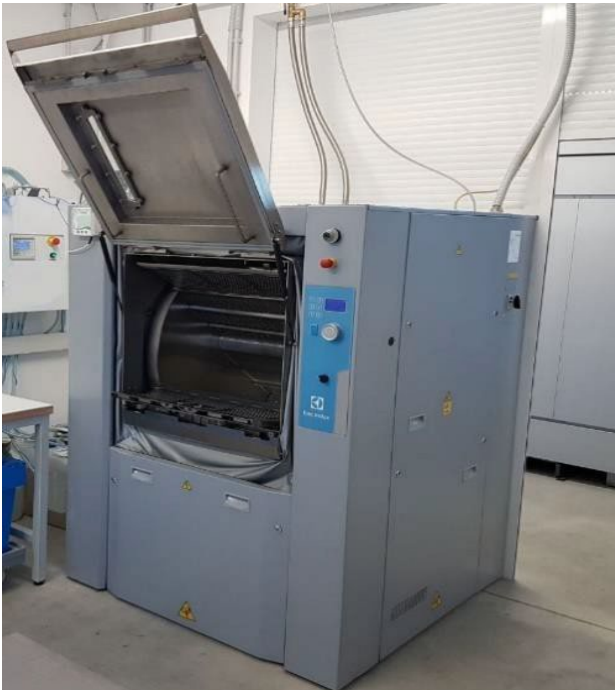
Figur 1. Barrierevaskemaskin på brannstasjoner som gir mulighet for inndeling i en forurensset sone og en ren sone i lokaler for håndtering og vasking av f.eks alarmstativer, undertøy og åndedrettsvern.
