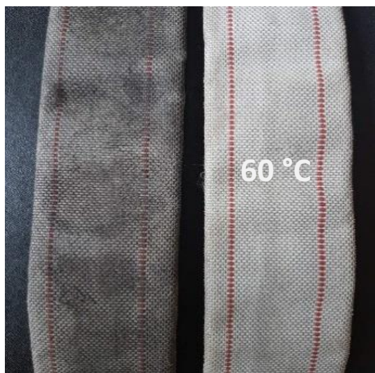
Sotforurenses brannslange før og etter bløtlegging og vask med Lejon Kemis slangevaskemiddel ved 60 °C.
