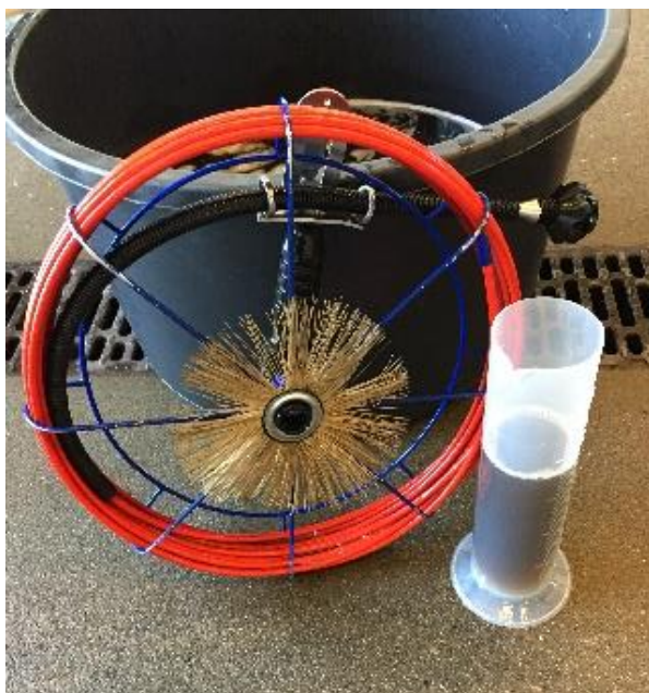
Feierverktøy etter manuell rengjøring med 5 % av Lejon Kemis rengjøringsmiddel FFE Cleaner i varmt vann (maks. 60 °C). Verktøyene ble så godt som helt rene. Begeret ved siden av verktøyene inneholder vaskevannet.
