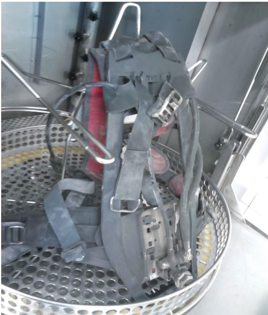
Deler av et sotete og skittent pustevernutstyr i en PPE-vaskemaskin.
