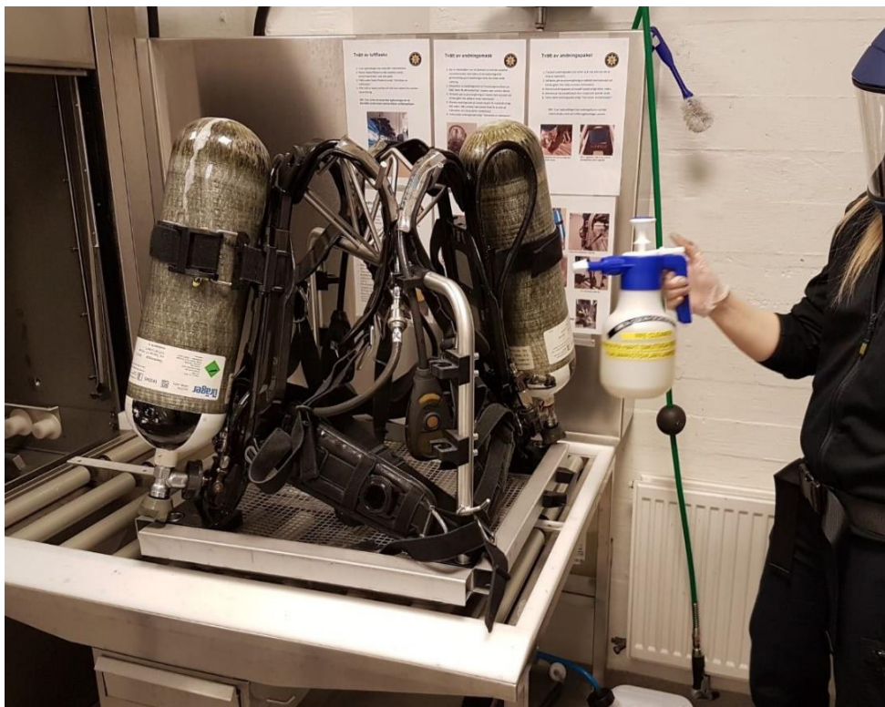
Dräger pustevernapparater forbehandles med Lejon Kemi sitt rengjøringsmiddel FFE Cleaner før de vaskes i en PPE-sprøytevasker av barrieremodell fra Wexiödisk AB i Oskarshamn, Sverige.
