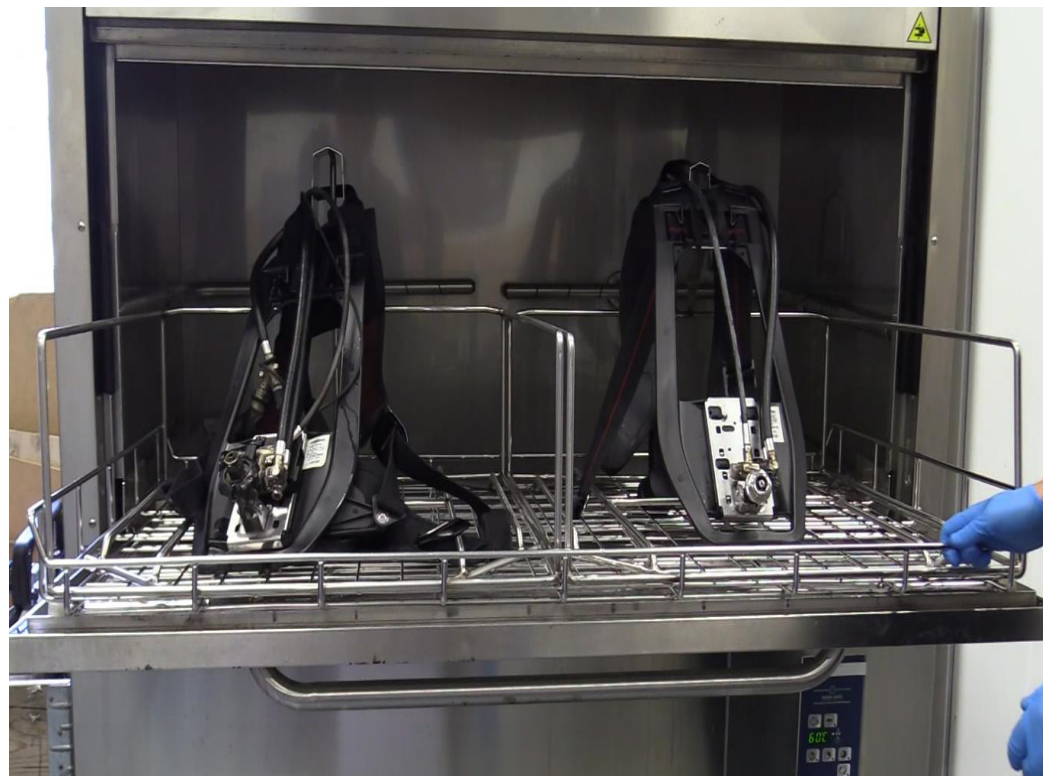
Deler av Interspiro pustevernapparater etter forbehandling og vask i PPE-sprøytevasker (WT 850) fra Electrolux Professional AB med Lejon Kemi FFE Cleaner ved et opplærings- og utdanningssenter for brannmenn tilknyttet Stockholms brannvesen.
