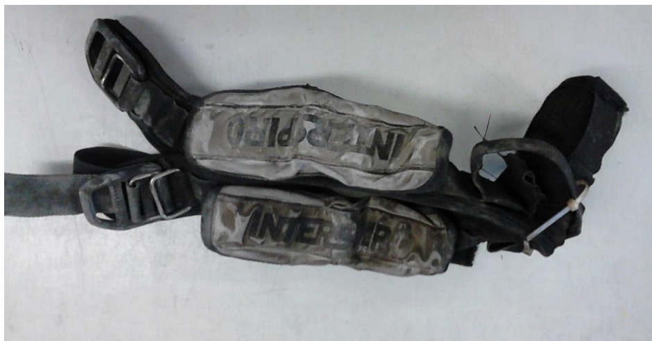
Bærestropper til pusteapparat forurensset med sot
