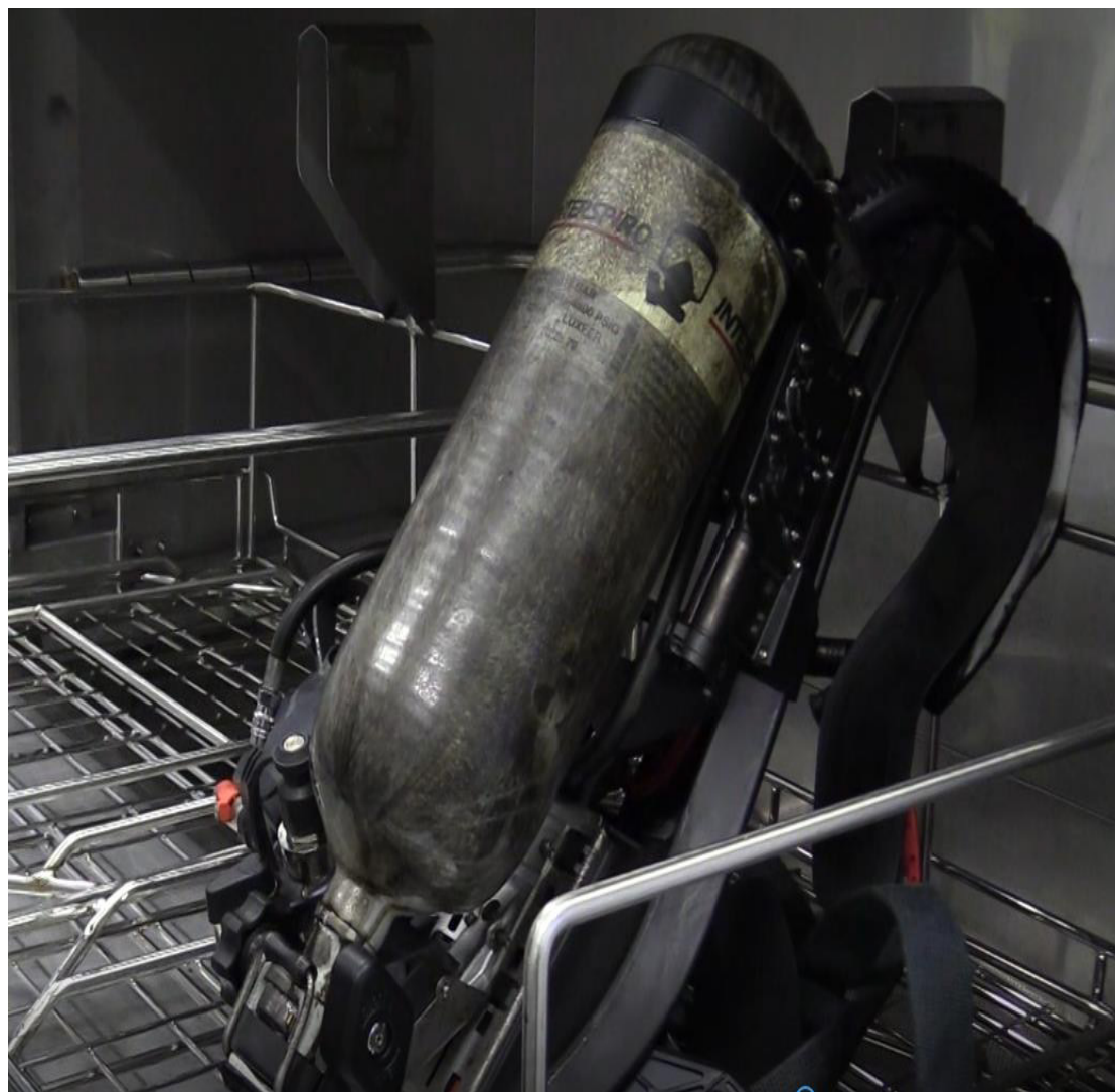
Sotete, forurensset pustevernutstyr i en PPE-spylervaskemaskin
