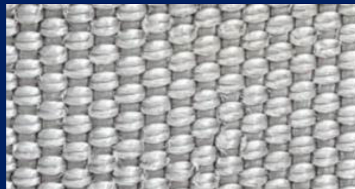
Forstørret bilde av rengjort brannslange
