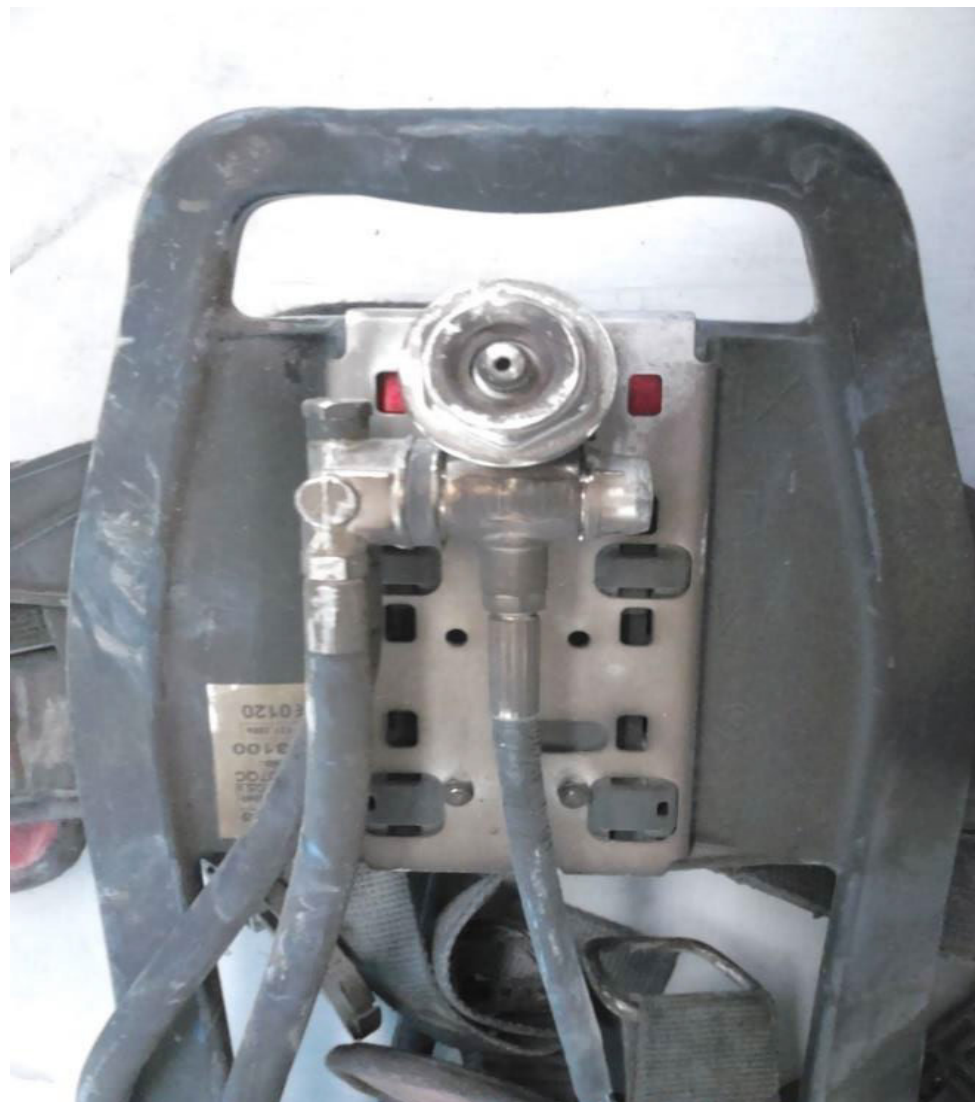
Sotforurenset ryggplate på et pustevernutstyr.
