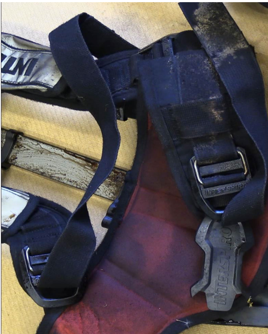
Skittent, sotbelagt del av selemonteringen.
