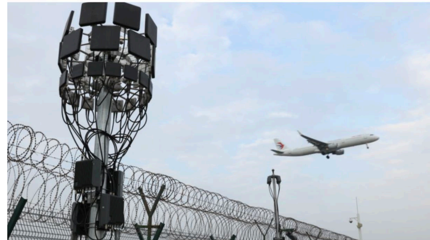
En utgave av det kinesiske systemet DJI Aeroscope installert på en utenlandsk flyplass. Illustrasjonsfoto: DJI
